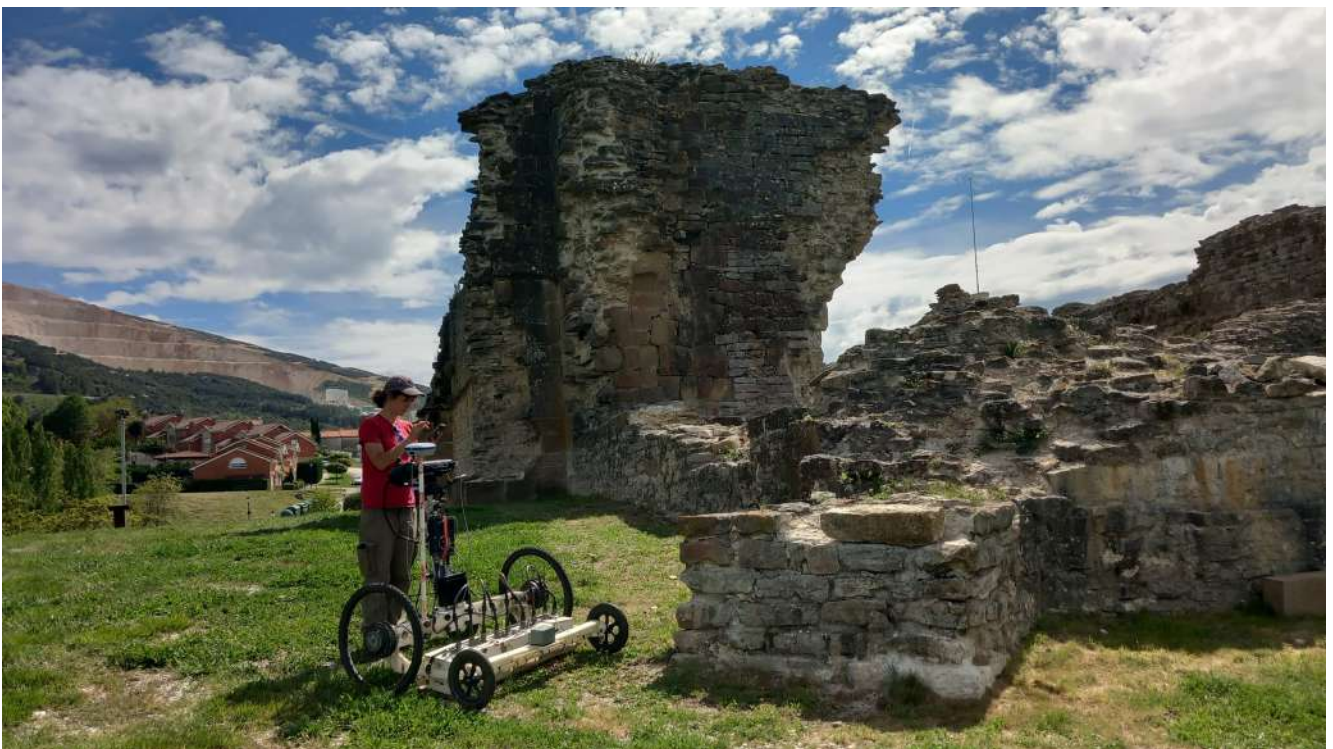
Figura 4: Fotografía del sistema georadar empleado.
